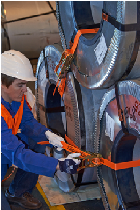
Abb. 1: Die Dynamic Load System besteht aus der Dynamic Load Ratsche und dem orangefarbenen EasyLashtex Gurtband.
