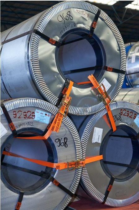
Abb. 2: Das Dynamic Load System ist besonders für die Sicherung von Coils auf Schiffen gut geeignet.
