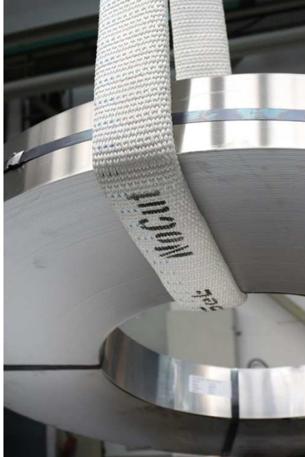
Abb.1: Wenden eines Coils mit einem Hebeband im schützenden NoCut sleeve.
