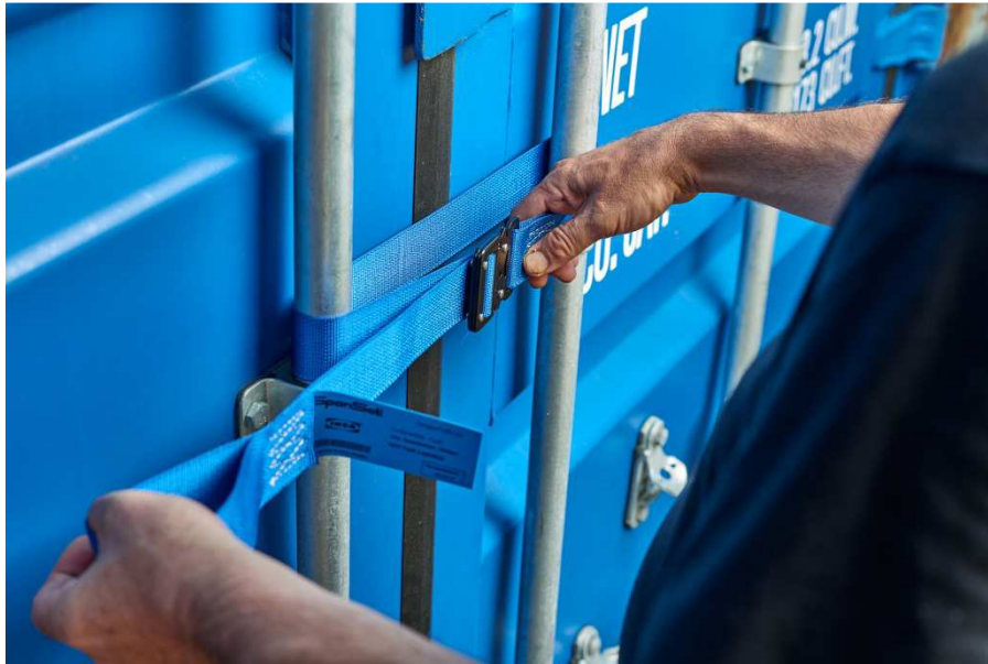
Abb. 5: CTUXafe verhindert das gefährliche, unkontrollierte Aufspringen von Containertüren durch verschobene Ladung.
