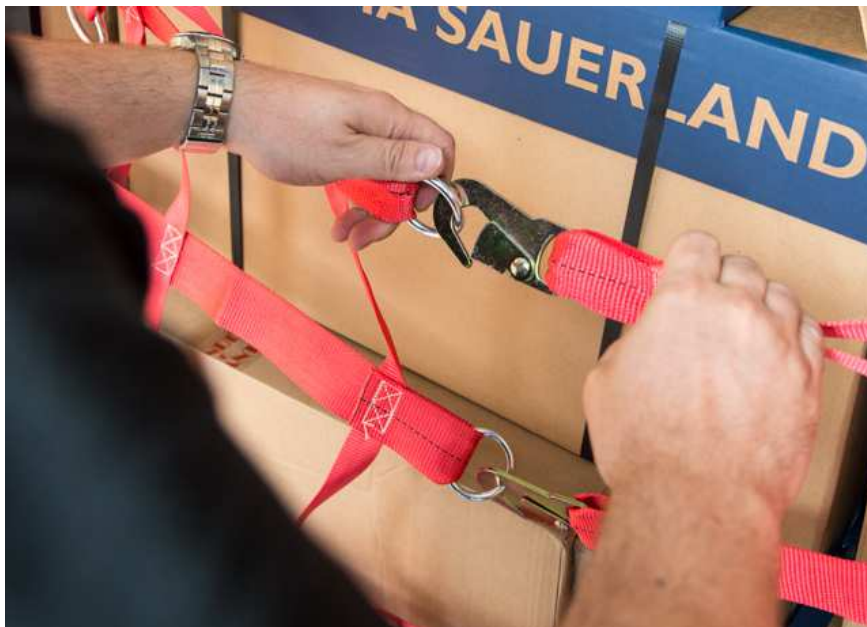
Abb. 4: Das Gurtbandnetz mit eingebautem „Reißverschluss“ ermöglicht den KEP-Diensten die einfache Entnahme einzelner Pakete.
