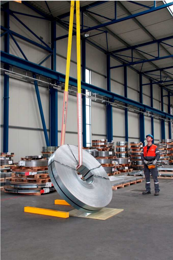
Abb. 2: Wenden eines Coils mit Hebeband im secutex-Schutzschlauch
