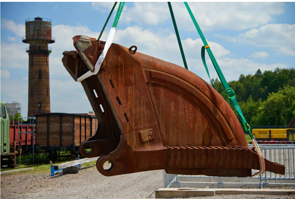
Abb. 4: Die Schaufel wurde hinten mit einem Hebeband mit secutex-Schutzschlauch ausgestattet. Im vorderen Bereich wurde mit einer Rundschnalle SupraPlus mit NoCut-Schutzschlauch angeschlagen.
