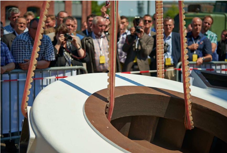
Abb. 6: Das Gehäuse wird mit 2 Hebebändern angeschlagen, die durch einen secutex-secuwave Schutzschlauch geschützt sind.
