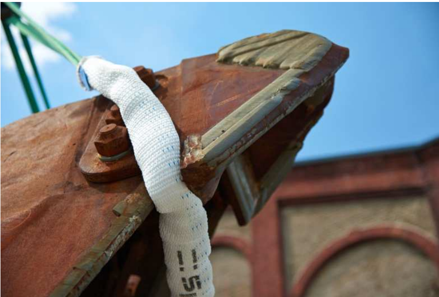
Abb. 5: Der NoCut Schutzschlauch liegt fest an der Kante der Baggerschaufel an.
