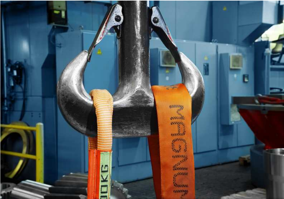
Abb. 3: Bei gleicher Tragfähigkeit kann die Magnum-X (links) an engere Kantenradien angelegt werden als herkömmliche Rundschlingen (hier: MagnumPlus, rechts).
