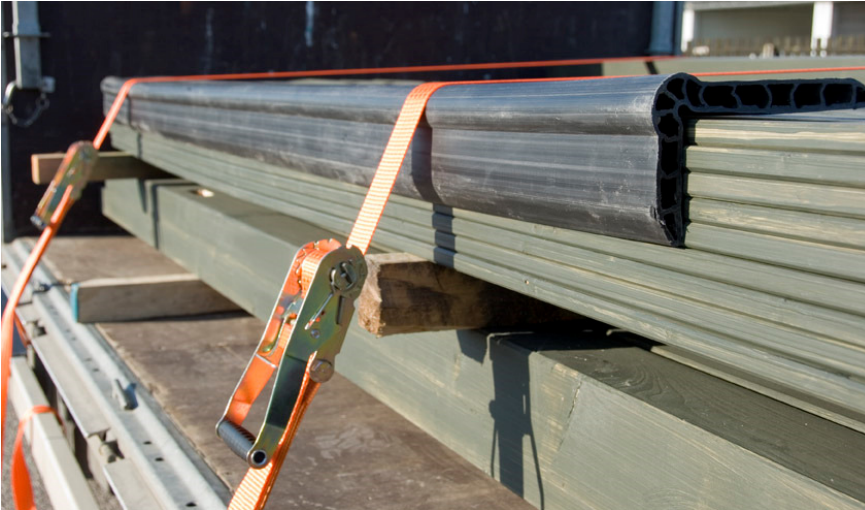
Abb. 2: Der Langkantenwinkel ist sehr robust und verwindungssteif und kann sogar Ladungslücken überbrücken.
