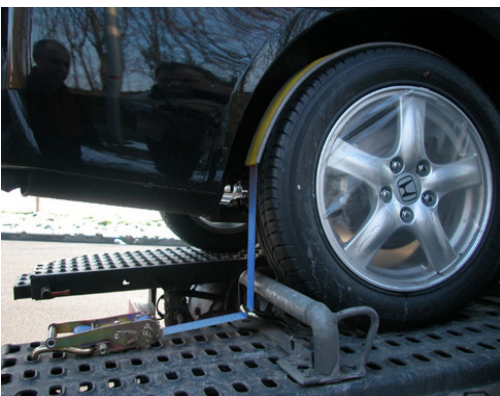
Abb. 3: Carfix - einfache und sichere Anbringung des Zurrgurtes durch Gurtcontroller und Dreipunkt-Sicherung am Lochblech.
