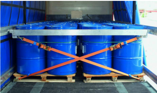
Abb. 1: Fässer, Big Bags u. v. m. können mit TruXafe formschlüssig gesichert werden. Dazu werden mit speziellen Aluminium-Seitenlatten und -Sperrbalken Ladungsabteile gebildet.
