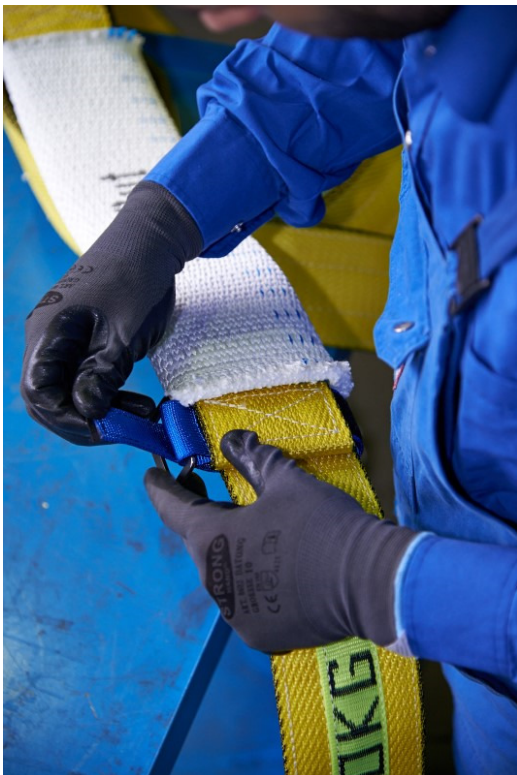
Abb. 2: NoCut pad wird mit seinen Befestigungselementen am Anschlagmittel fixiert.
