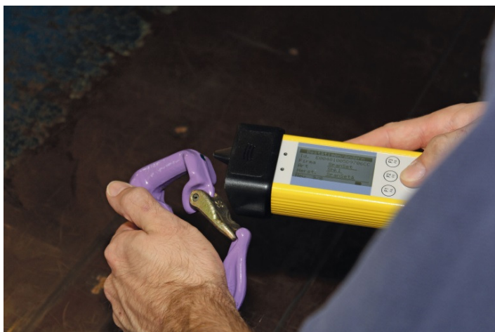
Abb. 2: Die neue Generation des IDXchanger kann auch Transponder im metallischen Umfeld auslesen und beschreiben.
