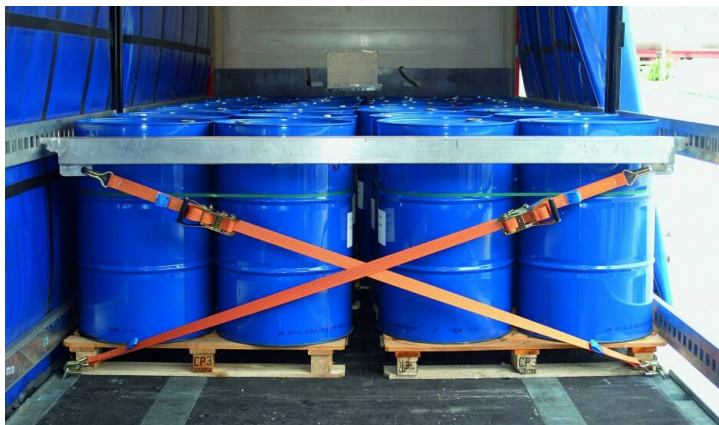
Abb. 1: Fässer, Big Bags u.v.m. können mit TruXafe formschlüssig gesichert werden. Dazu werden mit speziellen Aluminium-Seitenlatten und -Sperrbalken Ladungsabteile gebildet.
