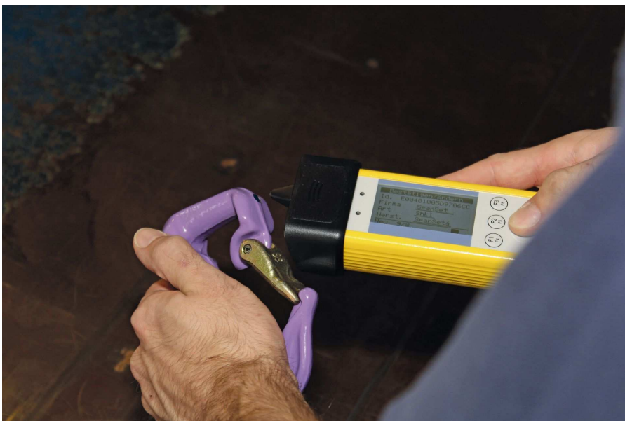
Abb. 1: Die neue Generation des IDXchanger MDE2 kann mit neuer Antennentechnologie auch Transponder im metallischen Umfeld (z.B. IDXpin) auslesen und beschreiben.
