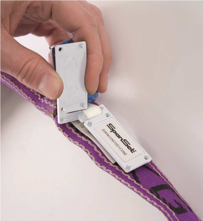
Abb. 2: Erst- und Nachrüstung von SpanSet Anschlagmittel mit dem neuen IDXclip, der mit der Gewebeschnaure des Anschlagmittels verbunden wird.
