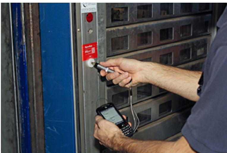
Abb. 3: Der neue IDXchanger MSLB (Schreib-/Lesegerät) funktioniert in Kombination mit dem Motorola ES 400. Der Datentransfer erfolgt via Bluetooth.
