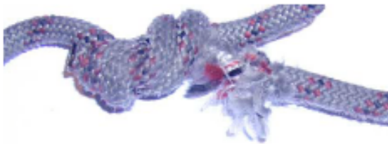
Abb. 1.: Faserbrüche am Knoten
