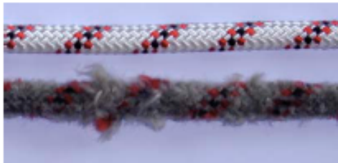
Abb.2: starker Seilabrieb, Abnutzung mit Seilverdickung
