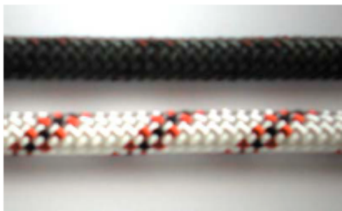
Abb.3: Schwarzfärbung des Seiles durch Bremsstaub
