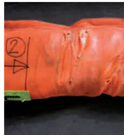
Typische Abdruckmarke nach einer Belastung mit dem Vierfachen der Nenntragfähigkeit bei gewebtem Rundschnlingenmantel
