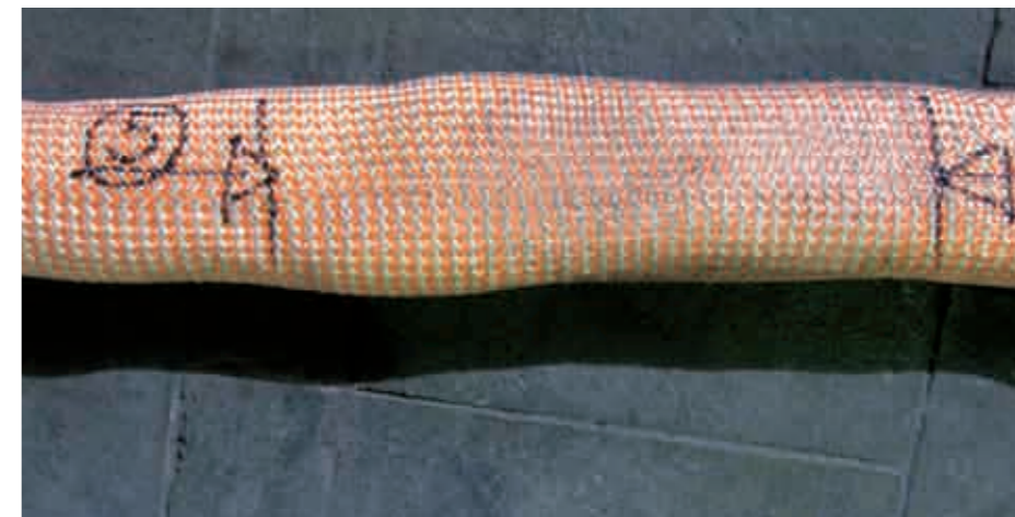
Dank innovativer Schlauchkonstruktion deutlich weniger Schäden am Schutzschlauch des Magnum-X-Rundschnlingenmantels nach einer Belastung mit dem Vierfachen der Nenntragfähigkeit
